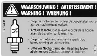
L'autocollant signale à l'opérateur d'arrêter le moteur et d'enlever le capuchon de bougie avant de commencer l'entretien de la machine.
