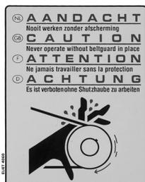
Cet autocollant est apposé sur le carter de la courroie de transmission. Cet autocollant indique qu'il peut être dangereux de déposer le carter de protection lorsque le moteur tourne. Il est interdit de travailler sans ce carter de protection. L'utilisateur doit toujours couper le moteur avant de déposer le carter de protection.
