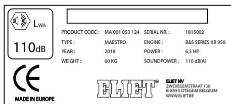
Cet autocollant porte l'étiquette d'identification de la machine, qui reprend les données suivantes:
