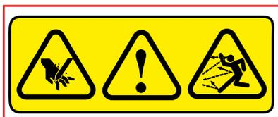
Ces icônes sont affichées sur le côté gauche de l'entonnoir. Cet autocollant signale de façon univoque le danger de graves lésions aux mains et d'éjection de déchets de coupe. Il est rigoureusement interdit de mettre les mains au-delà du déflecteur anti-projection !
