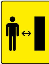
Cet autocollant est aussi sur le côté gauche de la goulotte d'alimentation. L'autocollant rappelle à l'utilisateur qu'il importe de ne pas laisser s'approcher des tierces personnes lors du fonctionnement de la machine.
